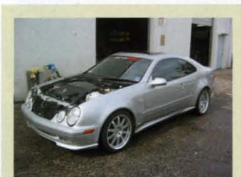
レンテックCLKのプログラムは比較的のボリュームなものだが、リヤフェンダーはかなり張り出しているのも特徴。その他ハイリフトカムにバルブスプリングの強化、スーパーチャージャー・ブーリーの拡大、そしてECUの書き換え。PP1はECUのみ、PP2はカムまわりの変更で414ps、最終段階は450ps/3.8ℓエンジンのPP3仕様だ。
